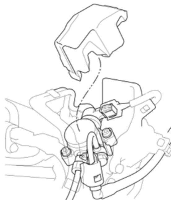
4. [燃油接管 - 拆卸](#)
