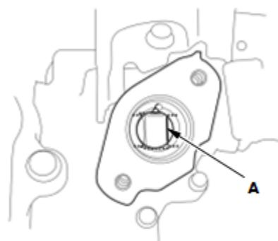
2. 将滚柱 (A) 安装到高压燃油泵凸轮上。
