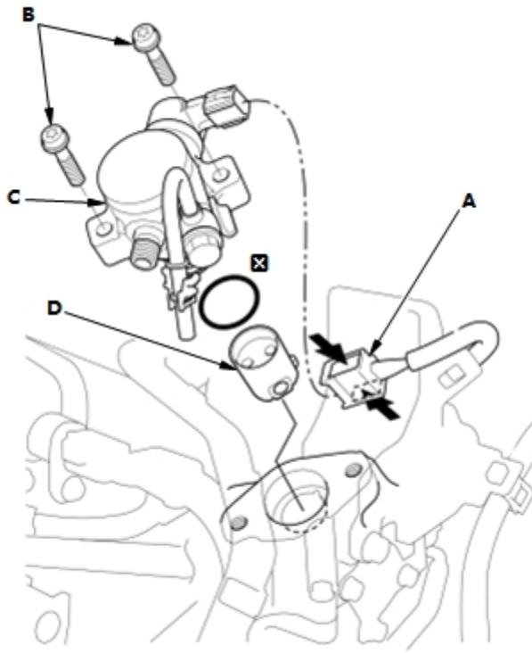
3. 从高压燃油泵 (B) 上拆下燃油供油管 (A)。
